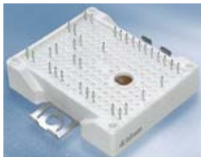
● Рис. 8. Внешний вид модуля EasyPACK™
